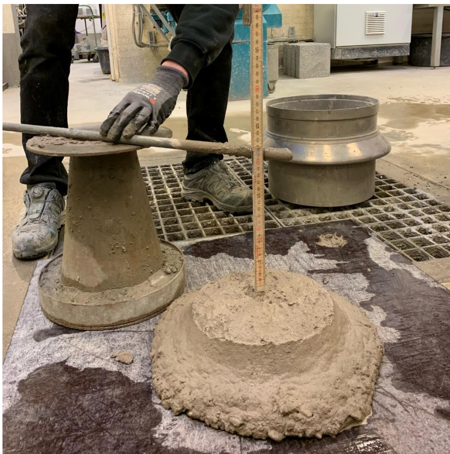
Figur 6: Prøveblanding af lavstyrkebeton med sætmål på 210 mm og et luftindhold på 6,2%.
